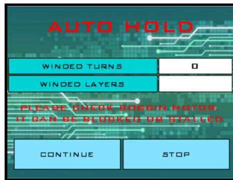
Abbildung 28: Bildschirm „ AUTO HOLD “ (Tachometersensor)
