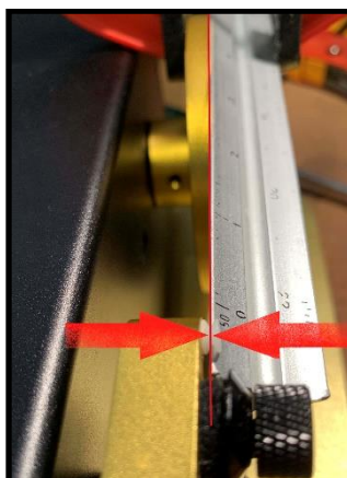
Imagen 15: Ajuste del offset para alinear el plato con la polea de guiado del hilo
