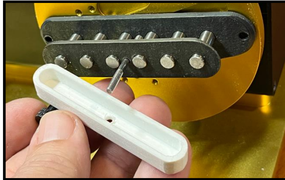
Imagen 3: Pieza especial para fijar bobinas sencillas
