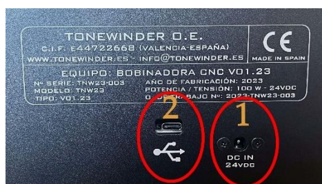
Imagen 64: Panel posterior con conector 24V y USB
