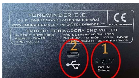
Image 64: Panneau arrière avec connecteur 24V et USB
