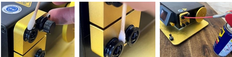
Abbildung 62: Schmierung der Riemenscheiben
