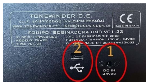
Abbildung 64: Rückwand mit USB-C- und 24-V-Stromanschluss
