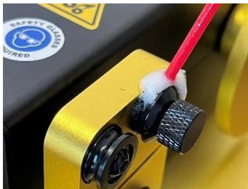
Abbildung 61: Schmieren der Drahtspannfilze
