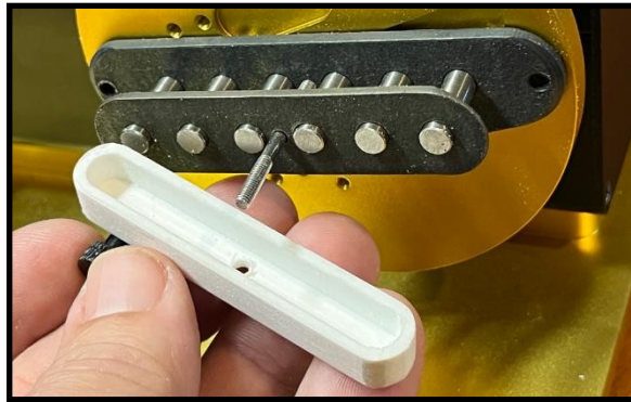
Abbildung 3: Spezialteil zur Befestigung einzelner Spulen
