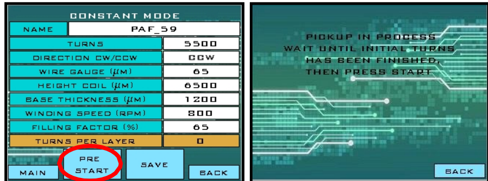
Abbildung 26: Drücken Sie " Vorstart ", um mit dem Wickeln zu beginnen
